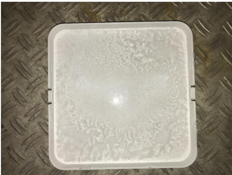
Figure H-2 : Intérieur du panneau extérieur après la fin du test
