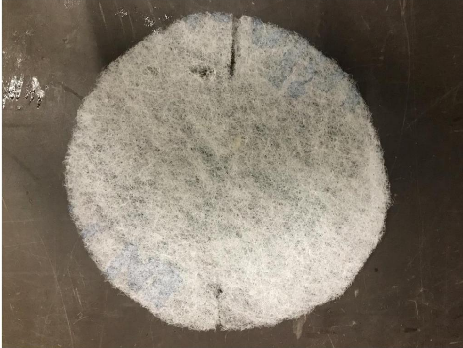
Figura A-6: Filtro ISO grossolano 30% (lato stanza)
