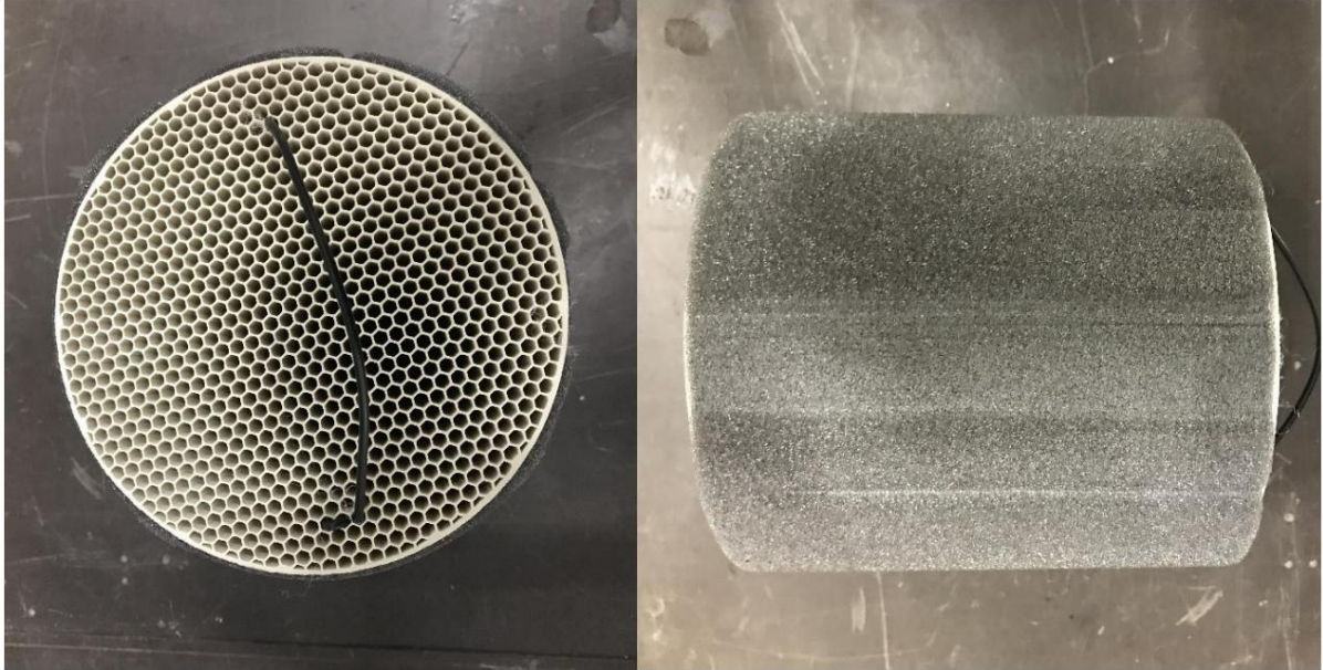
Figura A-10: Vista frontale e laterale dell'accumulatore di calore
